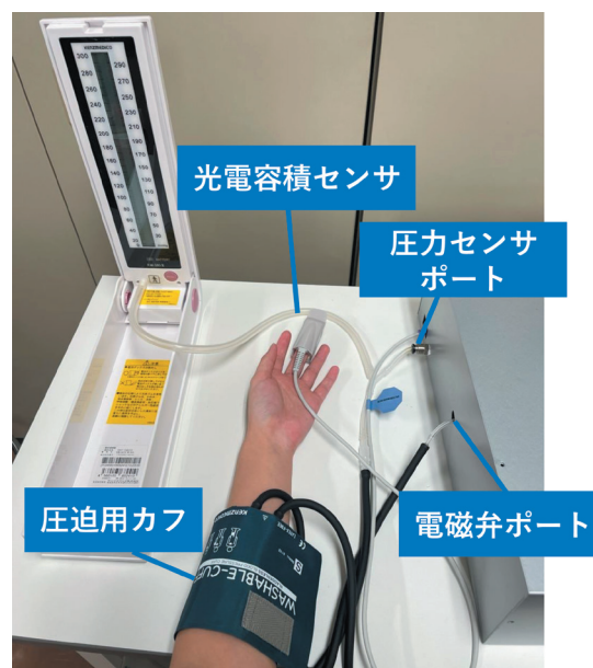
図 1 体肢圧迫を用いた PPG 法のセットアップ
