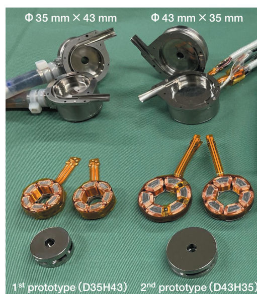
図2 機器植込みでの慢性動物試験を目指した補助人工心臓試験機の開発
