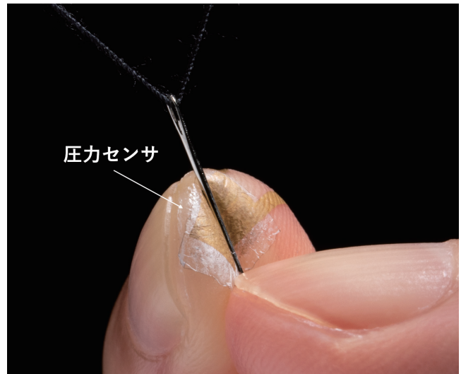
図6 ナノメッシュ構造を有する圧力センサ (文献8より改変転載)
