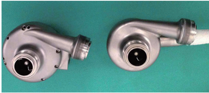
図2 体内植え込み式補助人工心臓EVAHEART 1とEVAHEART 2
