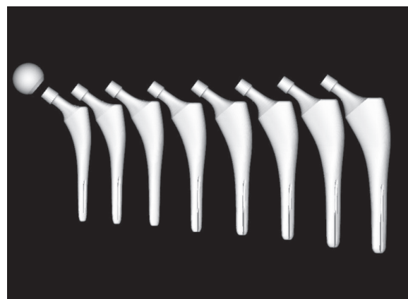
図4 日本人のCT画像による股関節の3次元形状解析に基づき 開発された、大腿骨近位部固定型の解剖学的短いステム 左上は28 mm骨頭(ボール)でスケール用に表示。8種類のステムサイズで、 骨格の小さな女性から大きな男性まで対応できるようにした。
