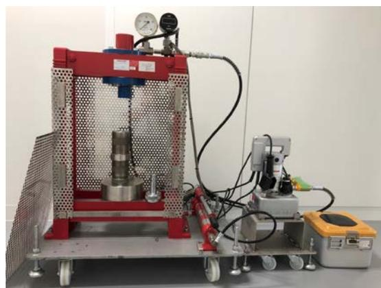
図3 母斑治療を可能にした小型組織加压装置(北岡鉄工株式会社)
