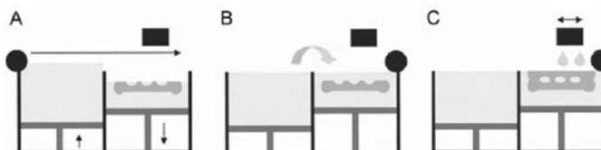
図2 3Dインクジェットプリンタを用いたカスタムメイド型人工骨 (CT-Bone) の作製
