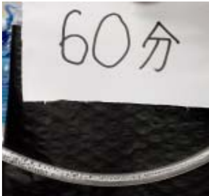
図 8 陰圧吸引補助ライン内の結露
